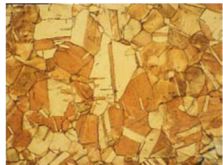
Чистая медь. Образец протравлен при помощи хлорида меди и нашатырного спирта. Увеличение 100х.
