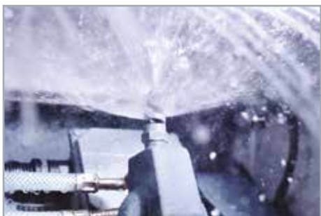
Автоматическая и ручная очистка отрезной камеры
