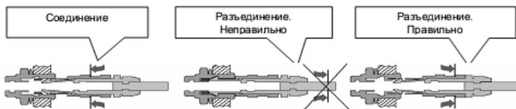
(Рисунок 6.2.). Манипулирование разъемами LEMO
