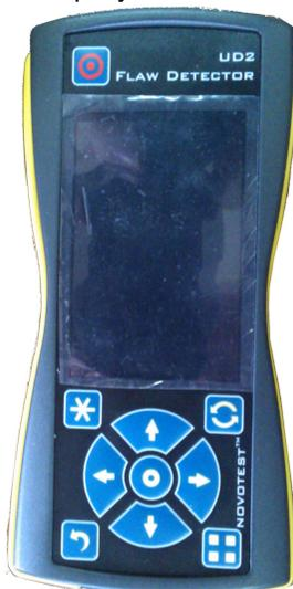
Рис. 6.1 Внешний вид дефектоскопа
