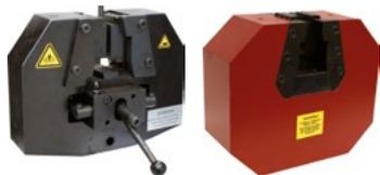
Захваты этого типа предназначены для статических испытаний на растяжение. Основной принцип работы – это фиксация образца клиньями силой, возрастающей прямо пропорционально усилию испытания. Существует два варианта – механическое исполнение для испытаний при нагрузках до 300 кН, и второй – автоматические с гидравлическим приводом для нагрузок до 2000 кН.
