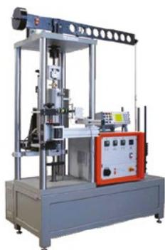
Серия испытательных машин LFM-СТМ оснащена различными наборами весов для создания постоянной нагрузки на образце и высокотемпературной печью с контроллером управления. На этих машинах проводятся долговременные испытания на длительную прочность (при постоянной нагрузке), релаксацию напряжений (постоянная деформация) при повышенных температурах. Одновременно может быть испытано до 3-х образцов благодаря увеличенной зоне нагрева печи.
