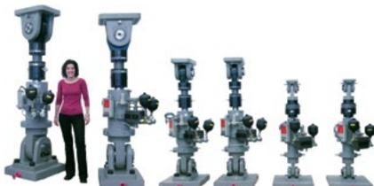
Применяются для статических, псевдодинамических, динамических высокоточных испытаний. Эти актуаторы имеют рабочие платформы с двух сторон для создания равного двухстороннего аксиального усилия на растяжение и сжатие. Точный датчик перемещения встроен в актуатор. Платформа гидрораспределителя для сервоклапана (сервоклапанов) и аккумуляторов смонтирована непосредственно на актуаторе. Такие актуаторы применяются для любых испытаний сооружений и крупногабаритных конструкций.
