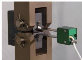
Экстензометр 3541 используется при испытаниях компактных образцов либо образцов другой геометрии с нанесенными надрезами при тестах на циклическую трещиностойкость в соответствии со стандартами ASTM E399 и другими. Стандартное исполнение позволяет получать данные о росте трещины при частоте испытания до 50 Гц.
