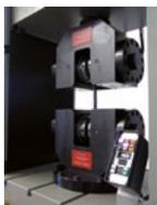
Гидравлические захваты серии SPG предназначены как для статических испытаний, так и динамических тестов с переходом через «0». Данная серия нашла применение и при биаксиальных испытаниях, например при растяжении с кручением. Диапазон нагрузок от 160 до 3000 кН.
