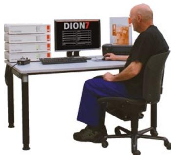
Система PCS-8000 является гибкой модульной системой сбора данных и управления для гидравлических и электро-механических испытательных машин, поддерживающей расширение. Используя до двенадцати модулей, систему можно адаптировать к различным требованиям. Несколько контроллеров можно соединить вместе для создания синхронизированной многоканальной испытательной системы с частотой выборки данных до 8 000 Гц.
