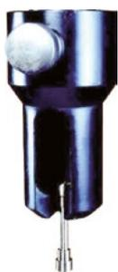
Захваты предназначены для статических испытаний на растяжение пропорциональных «Гагаринских» образцов, а также образцов с резьбовыми хвостовиками. Доступно несколько вариантов от простейших адаптеров до захватов с улучшенным центрированием и механическим либо гидравлическим поджатием, что позволяет использовать оснастку в комбинации с экстензометрами.
