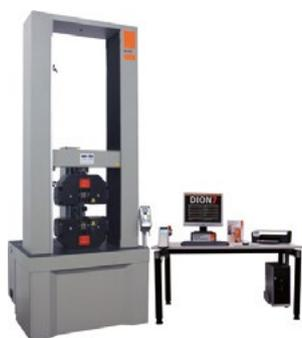
Универсальные испытательные машины в четырехколонном исполнении с возможностью преднагружения, безлюфтовой шариковинтовой парой, с дополнительными прочными опорными колоннами, гарантирующими строгую геометрию перемещения подвижной траверсы. Применяются не только для испытаний на растяжение, сжатие и изгиб, но и для испытаний «через 0». Шариковинтовая пара управляется с помощью высокоточного бесщеточного электродвигателя переменного тока с цифровым управлением.
