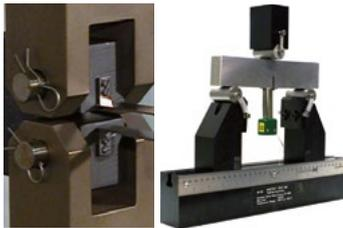
Карабинные захваты предназначены для испытаний компактных образцов (СТ), а оснастка на изгиб позволяет проводить испытания образцов-балочек с предварительно нанесенными надрезами. Оба варианта оснастки предназначены для испытаний на циклическую трещиностойкость в соответствии со стандартом ASTM E399 и другими.
