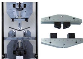
Универсальная оснастка имеет регулируемое расстояние между опорами в диапазоне от 50 до 500 мм, а также сменные ролики пуансона и опор различных диаметров. Максимальная нагрузка при испытании составляет 2000 кН. Оснастка устанавливается на захваты для растяжения, что позволяет быстро и с удобством переходить от одного типа испытания к другому.
