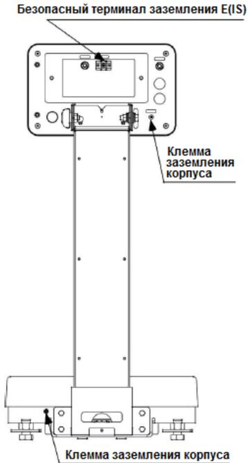
В этом продукте внутренние схемы электрически соединены с корпусом.
