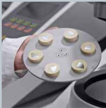
Выньте полностью очищенные и сухие образцы.
