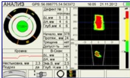
В левой верхней части экрана отображается совмещенное изображение сечения сварного шва и кромки, на котором приведена информация о сечении сварного шва, положении шва относительно расположения сканера и смещении кромок сварного шва.
