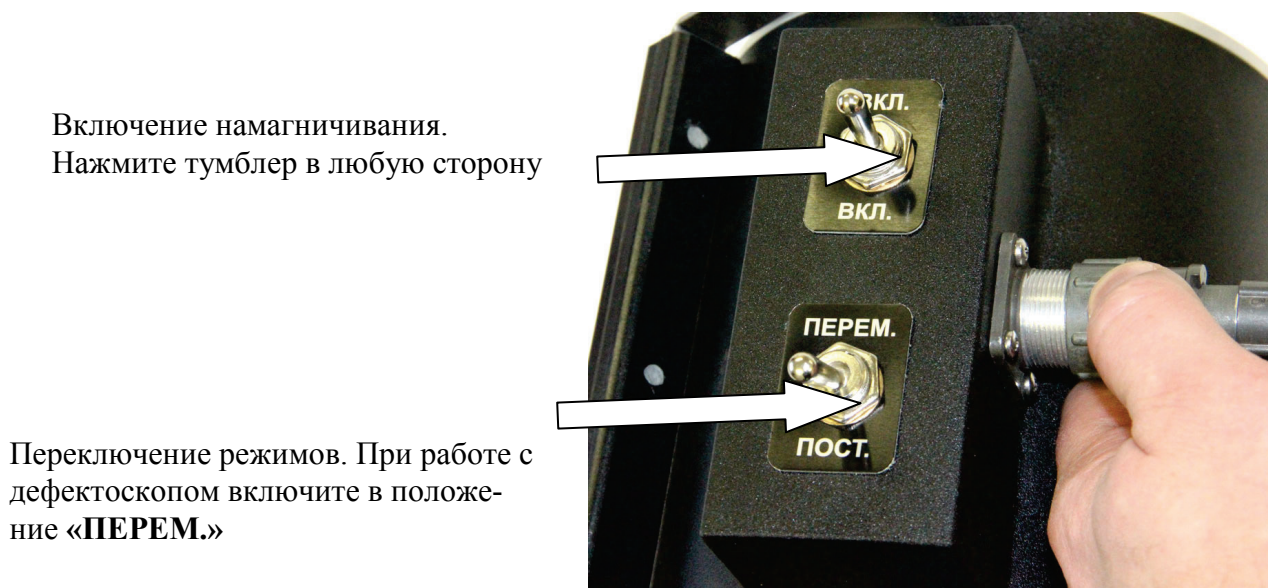
Рис 4.9 Подключение провода и управление соленоидом
