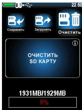
Очистка сохраненных записей в архиве и резервных копий калибровок: после очистки SD карты архив будет пуст и резервные копии калибровок удалены. Для очистки только сохраненных архивных записей - скопируйте сохраненные измерения на ПК со специальным программным обеспечением. Таким образом, резервные калибровки не будут затронуты.
