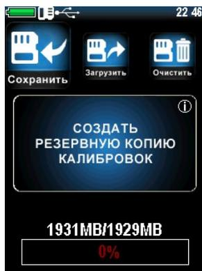
После калибровки датчика рекомендуется создать резервную копию калибровки (обычно производитель делает калибровку по 1-2 шкалам, для проверки преобразователя). Это делается для того, чтобы иметь возможность возобновить надлежащую калибровку после неправильных настроек в будущем.
