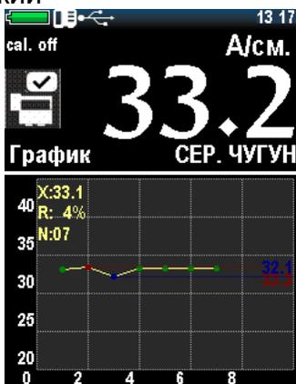
В данном режиме, прибор отображает значение текущего измерения или среднего по серии измерений, в зависимости от настроек в настройках меню:
