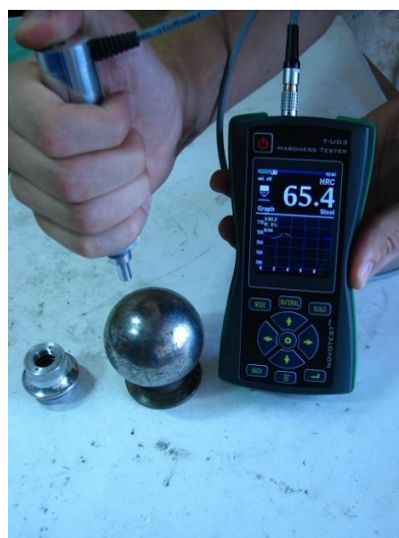
Измерение твердости шаров
