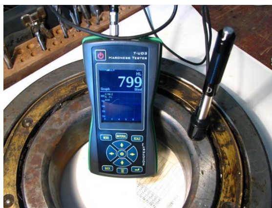
Измерение твердости массивных деталей, например, подшипников
