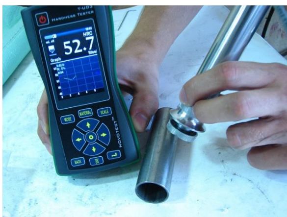
Измерение твердости изделий с тонкой стенкой
