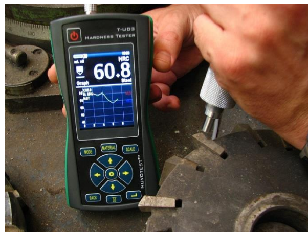
Измерение твердости зубьев
