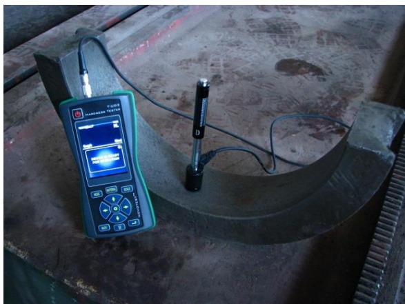
Измерение твердости литых деталей
