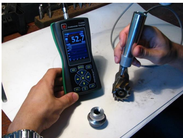
Измерение твердости небольших деталей сложной формы
