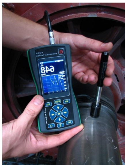
Измерение твердости валов
