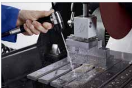
Промывочный пистолет, облегчающий очистку станка
