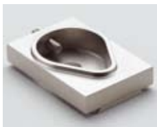
Держатель CATFF для круглых и квадратных образцов. Зажим типа слезинки с отверстиями диаметром 15-40мм.
