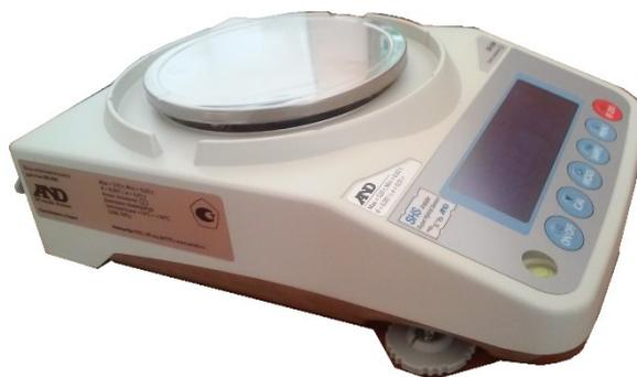
Рисунок 1 – Общий вид весов неавтоматического действия DX
