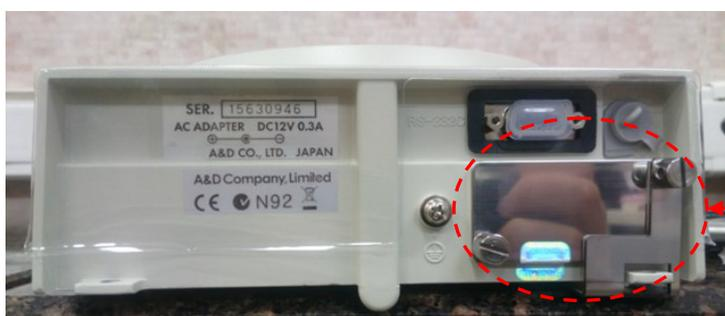
Место пломбировки с помощью разрушаемой наклейки и/или проволоочной пломбы
